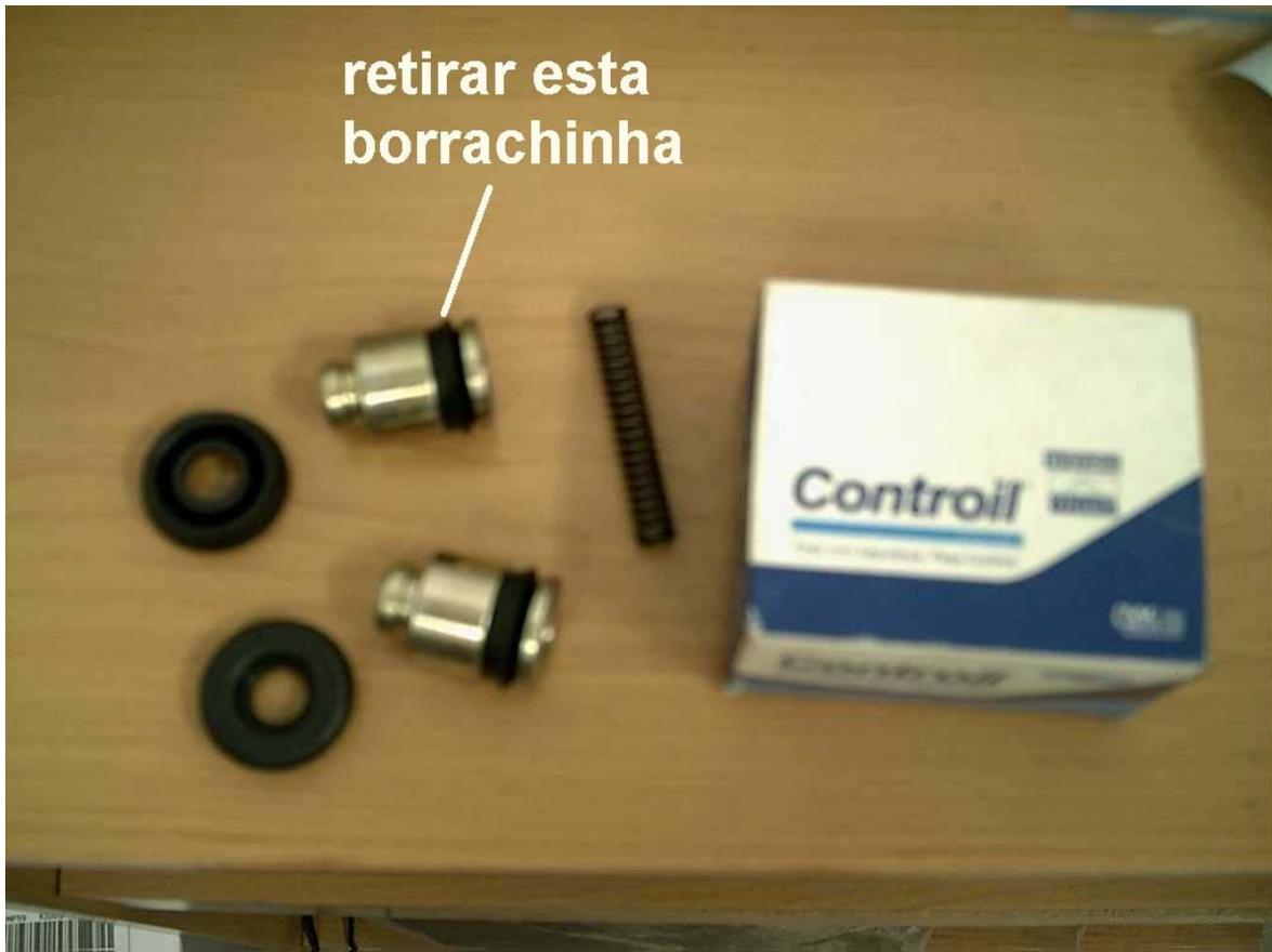
Agora é necessário substituir a borrachinha velha pela nova, e isso requer muita paciência e cuidado pois há o risco de rasgar a borracha tanto na hora de tira-la como na hora de coloca-la no reparo do Omega. O ideal é utilizar uma chave de fenda pequena com a ponta bem arredondada, ou seja, sem pontas cortantes. Observe bem o sentido da borrachinha, antes de desmontar.
