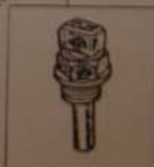
SENSOR DE TEMPERATURA DO MOTOR -NO FLANGE DE ÁGUA DO CABEOTE
