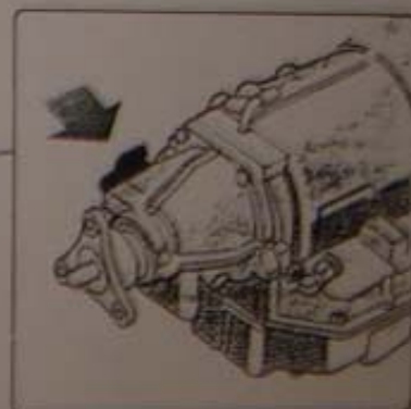
SENSOR DE VELOCIDADE NA TRANSMISSÃO LADO ESQUERDO (PARTE TRASEIRA)
