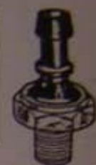
INTER DA PRESSÃO DO ÓLEO DO MOTOR
