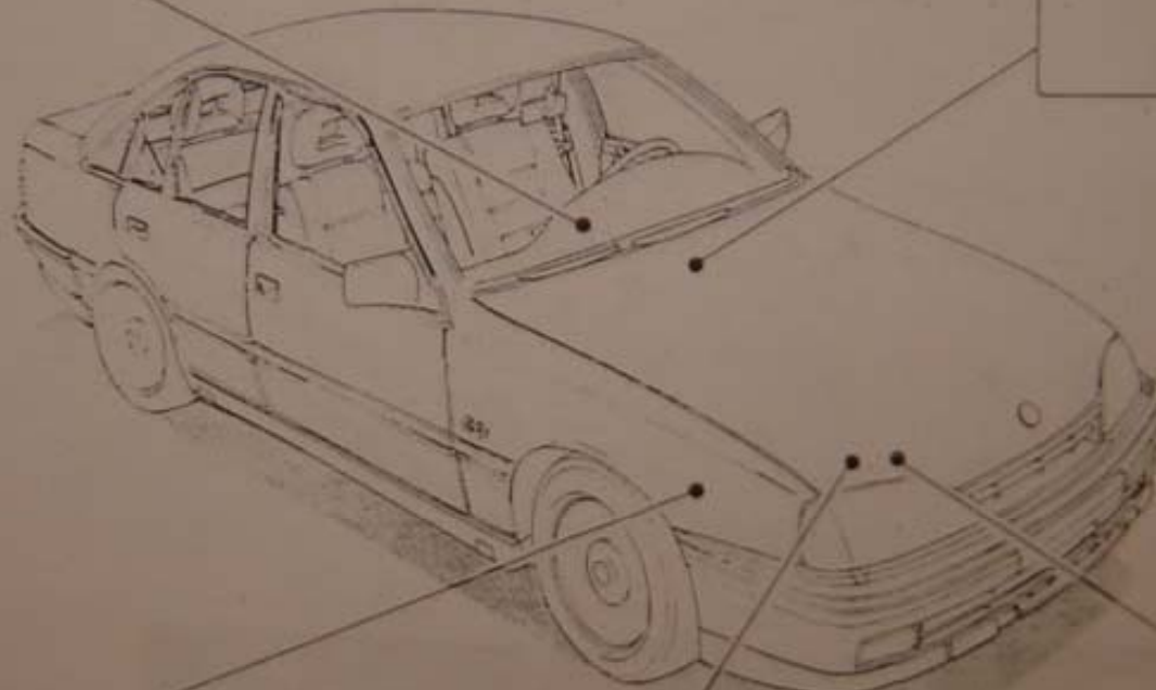
UNIDADE DE AJUSTE DA VENTILAÇÃO - NO COMANDO DA VENTILAÇÃO - PRÓXIMO AO PAINEL DE INSTRUMENTOS
