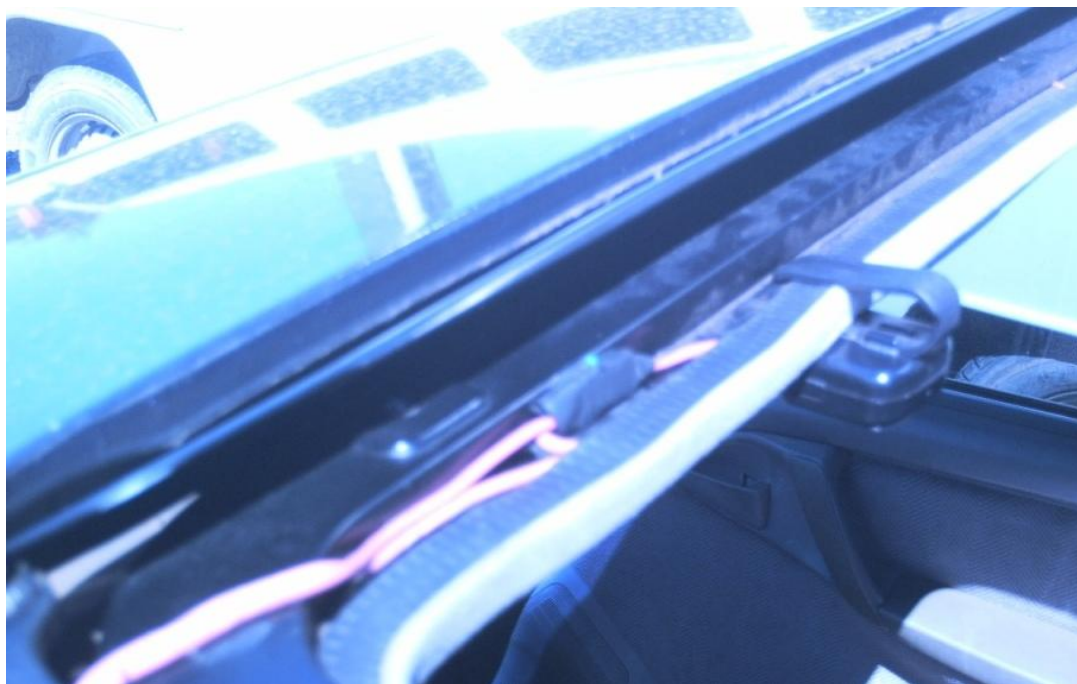
FOTO 5: POSICIONAMENTO DA MICRO-CHAVE 1 SEM ACIONAR.
