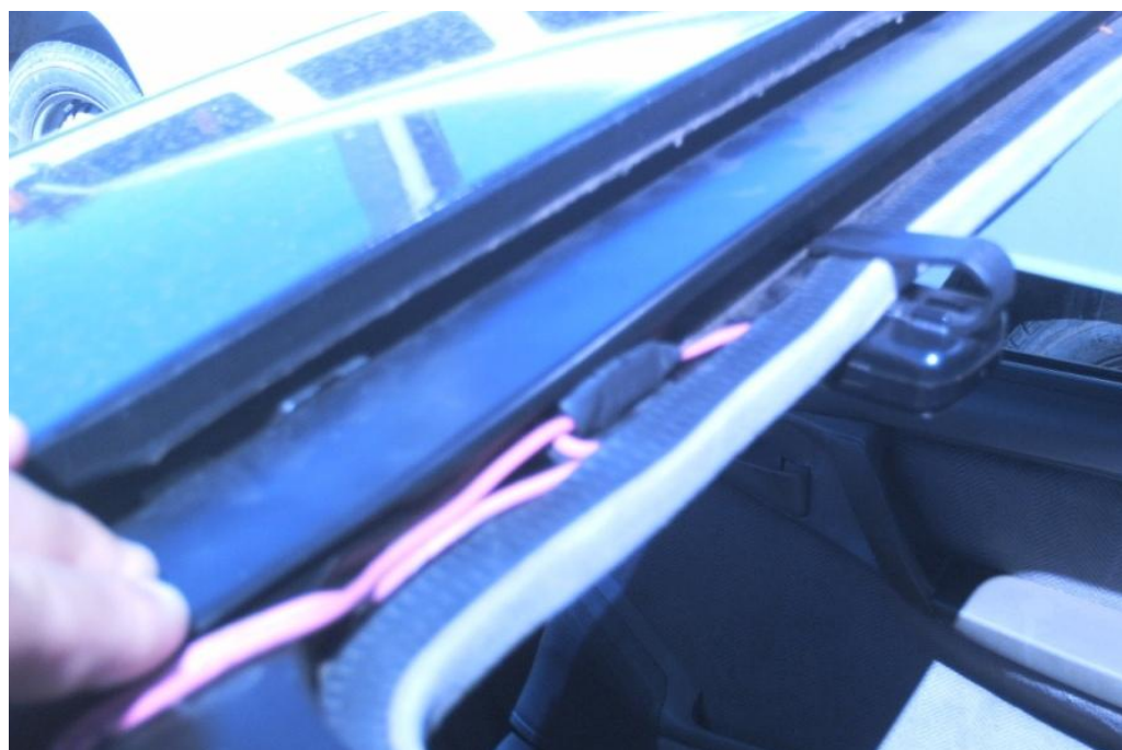
FOTO 6: POSICIONAMENTO DA MICRO-CHAVE 1 ACIONADO.
