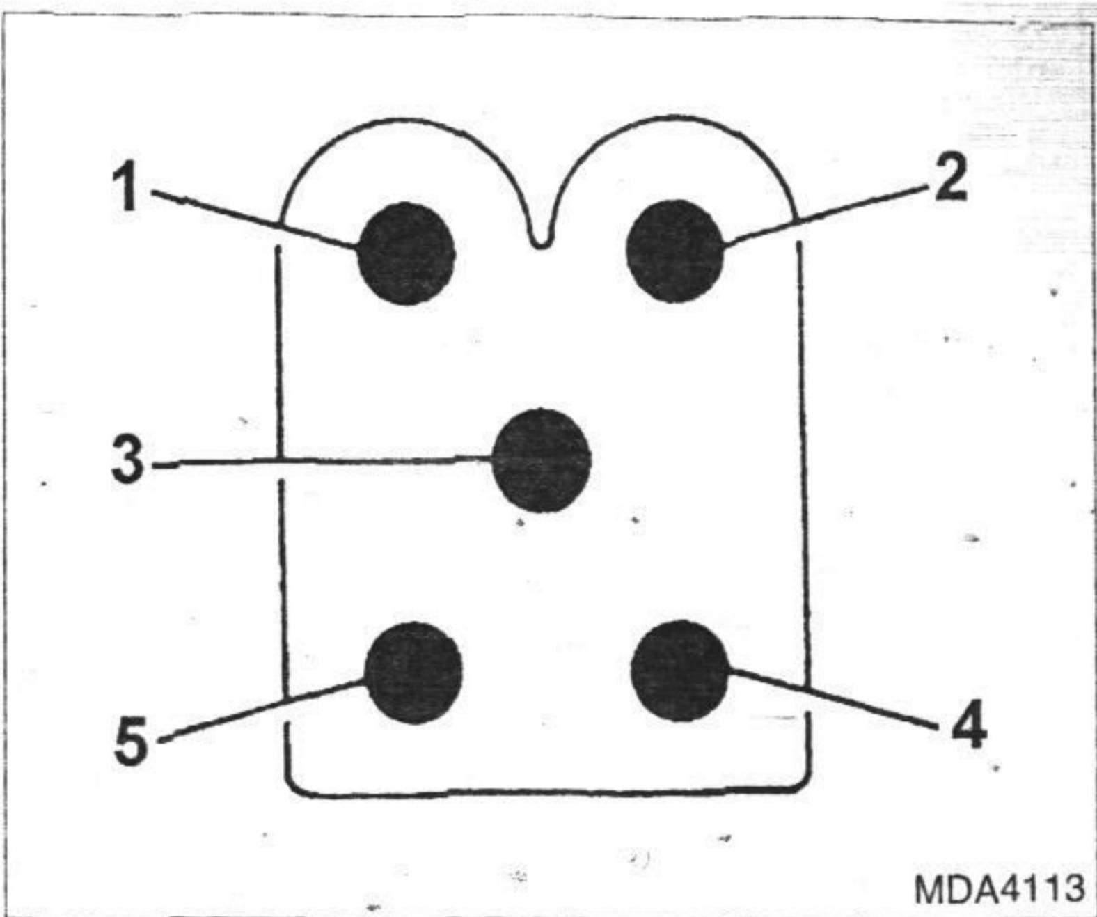
**5.3 Conector de 10 pinos para o comutador do ventilador, condicionador de ar (no dispositivo de serviço)**
