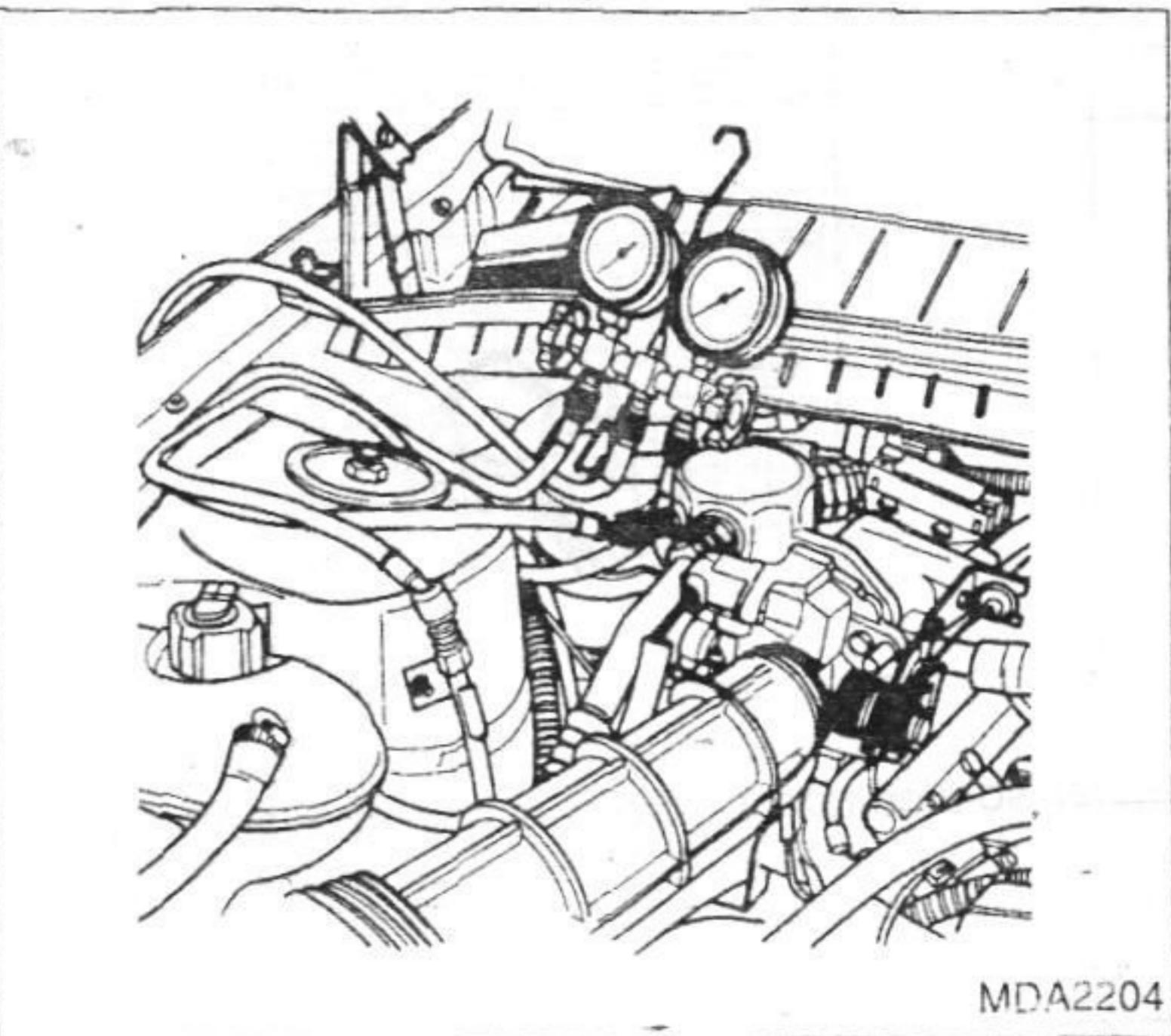
Medir a temperatura com o termômetro digital ou com o termômetro de haste, à frente do condensador nos difusores e comparar com os valores nominais de desempenho.
